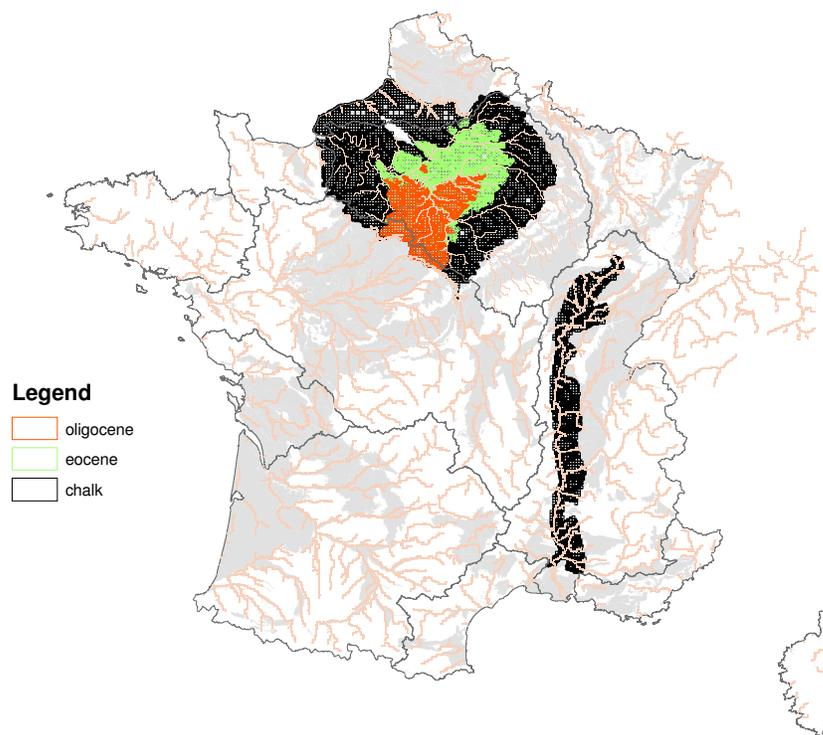
Figure 3. Simulated aquifers (cells) and main aquifers as defined in the BDRHF (Base de Données sur le Référentiel Hydrogéologique Français; <http://sandre.eaufrance.fr>) hydrogeological database (dashed)
