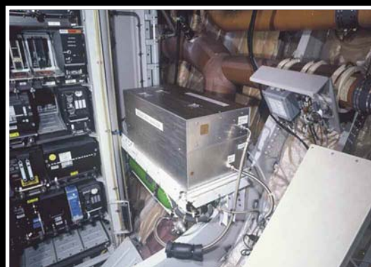
Figure 2a et 2b - Instrumentation Mozaic installée dans la soute avionique de l'A340, sous le cockpit de pilotage. (a) l'étagère installée en 1994 et comprenant de haut en bas l'instrument O_3 , le système d'acquisition, l'instrument CO, les pompes et le module d'alimentation (poids total 134 kg). (b) l'instrument NO, installé en 2001 (poids 50 kg).
