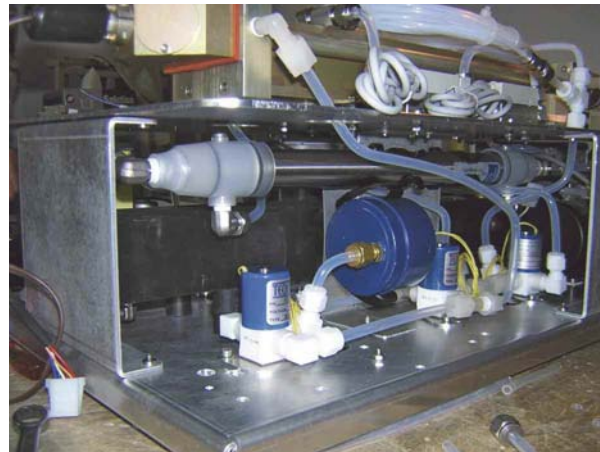
Figure 10 - Le prototype Iagos-Package I qui combinera les mesures d'ozone, de monoxyde de carbone, de vapeur d'eau, le comptage des hydrométéores et les systèmes d'acquisition et de transmission des données (responsabilité : Laboratoire d'aérodynamique, en collaboration avec le FZJ et l'université de Manchester).
