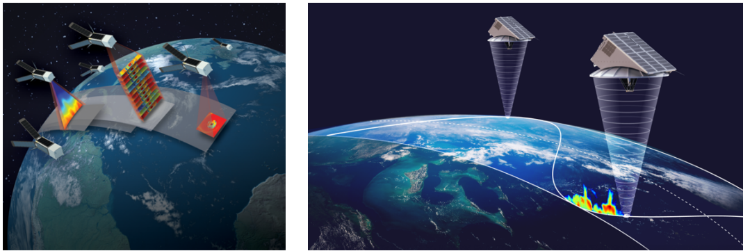
Figure 44 : (Gauche) Vue d'artiste de la constellation TROPICS pour le sondage de l'humidité, les nuages et les précipitations par radiométrie micro-ondes passive. (Droite) Vue d'artiste de la constellation de radars de Tomorrow.io.
