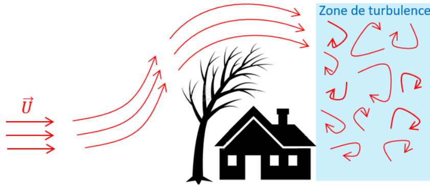
FIGURE 1.2 – Représentation schématique de la turbulence d’origine mécanique : la modification de la trajectoire du vent ( \vec{U} ) par un obstacle, et la création d’une zone de turbulence mécanique.
