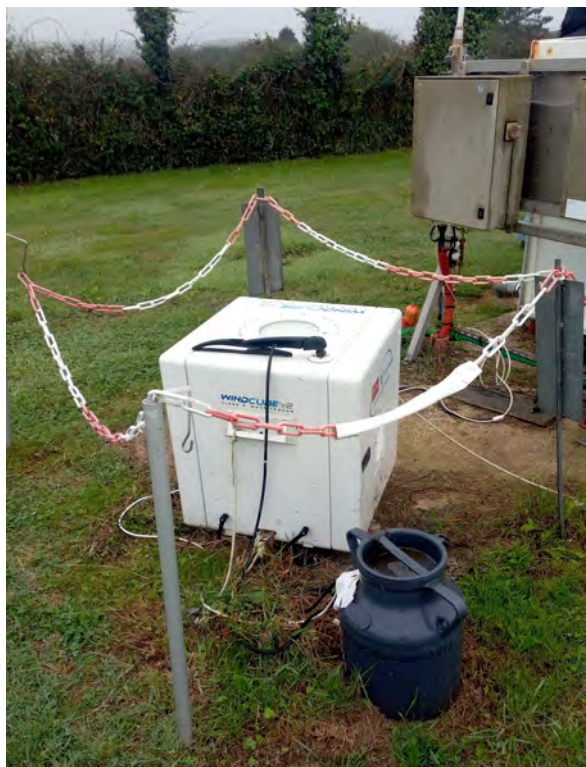
FIGURE 2.7 – Photographie du Lidar Doppler (version Leosphere Windcube 2) installé dans la station PTILH, et utilisé dans ce manuscrit.
