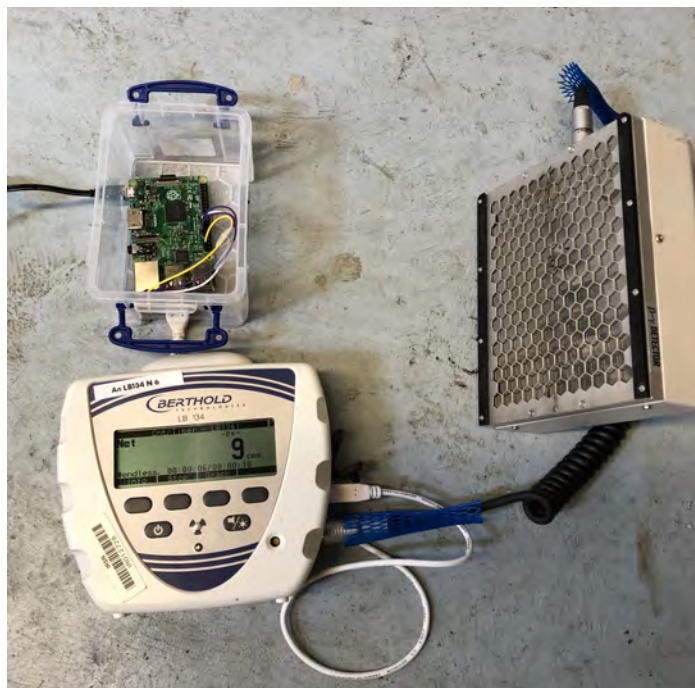
FIGURE 2.10 – Compteur \beta proportionnel Berthold LB134, utilisé pour le calcul de l'activité volumique du ^{85}\text{Kr} dans la station LRC.
